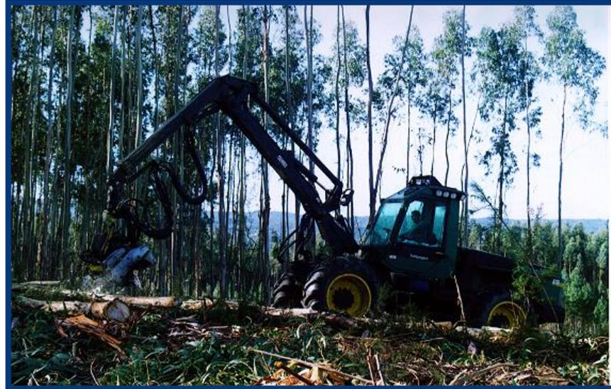
O **corte** é a operação florestal que gera a BFR, utilizando-se desde ferramentas semi-manuais ou manuais como as motosserras, motorroçadoras, machados, etc., até aos sofisticados *harvesters*, ou outras máquinas adaptadas com cabeça processadora.
