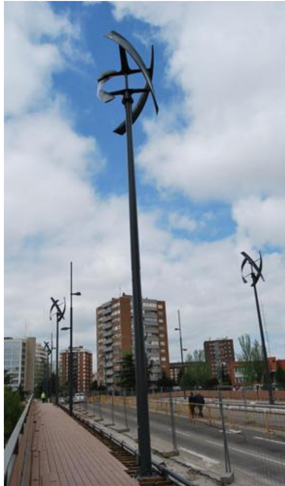
Microeólicas de Eixo Vertical em Ambiente Urbano (Urban Green Energy - EUA)
