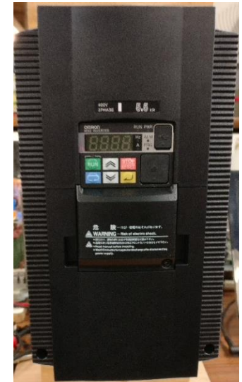
Variador de Velocidade
