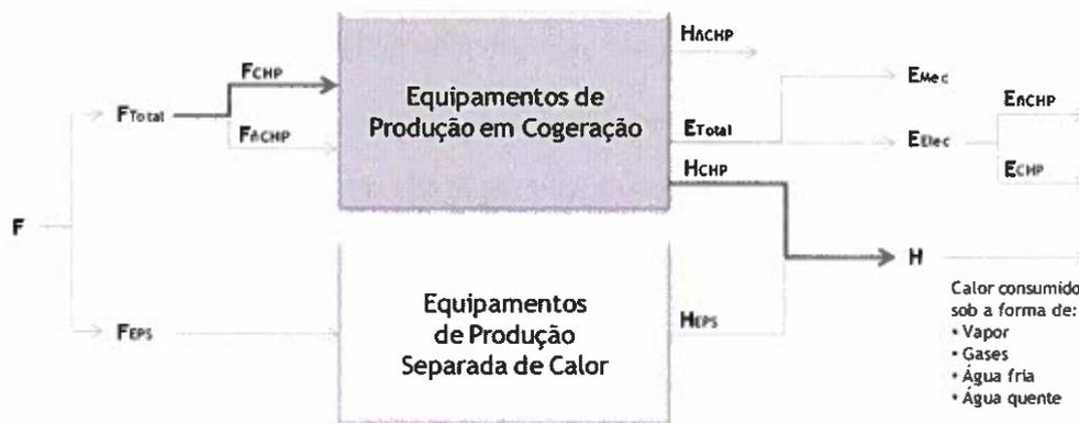
Figura 4 – Representação gráfica de uma Instalação de Produção de energia para aquecimento e arrefecimento e identificação das principais variáveis objeto de medição.
