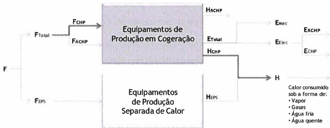
Figura 4 – Representação gráfica de uma **Instalação de Cogeração** com equipamentos de produção em cogeração (processo ou unidade de cogeração) e equipamentos de produção separada de calor e identificação das principais variáveis objeto de medição.
